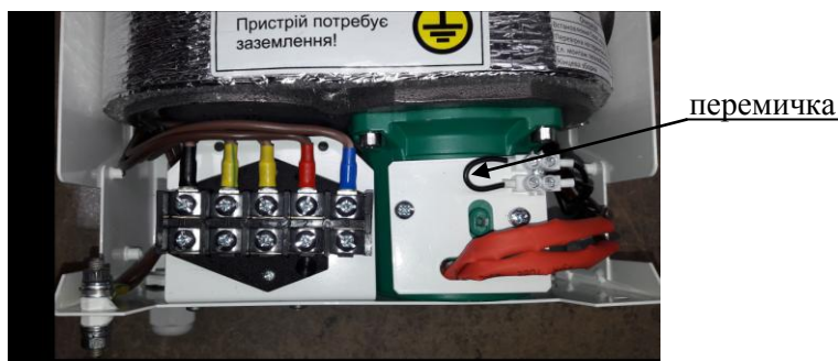
Рис. 26 Перемичка, яку необхідно видалити перед підключенням зовнішнього керування
